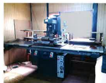
高周波ウェルダ加工機 前後2段スライド方式 出力: 7 kw ヒーター付き 精電舎電子工業
