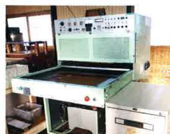
高周波ウェルダ加工機 左右スライド方式 出力: 7 kw ヒーター付き 特殊電気工業
