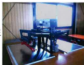
高周波ウェルダ加工機 左右スライド方式 出力: 7 kw ヒーター付き 特殊電気工業
