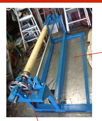
太巻き専用台座 紙管を固定するチャック部分にはベアリングを 装着し、重量のある生地でも出来るだけテンションが かからない設計になっています。 また、シャフト方式にも対応しています。
